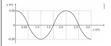
Sabendo-se que a onda se propaga com velocidade de 4 m/s, o comprimento de onda, o período e a frequência do movimento são respectivamente iguais a
