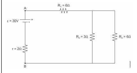
**17. (EEAR)** Em uma aula de laboratório o professor montou um circuito com 3 resistores ôhmicos  $R_1$ ,  $R_2$  e  $R_3$  associados a uma fonte de alimentação ideal (Vt) conforme o circuito abaixo. E solicitou ao aluno que, usando um amperímetro ideal, medisse o valor da intensidade de corrente elétrica que flui através de  $R_2$ .
