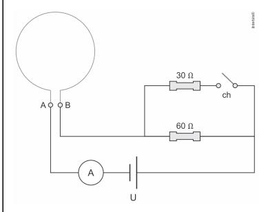
Quando a chave é mantida aberta, o amperímetro indica a passagem de uma corrente elétrica de 6A. Determine a diferença de potencial U do gerador e, em seguida, a intensidade da corrente elétrica que passa pelo amperímetro quando a chave está fechada.
